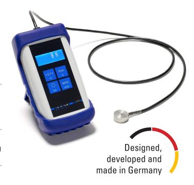
Dieses vollelektronische Kraftmessgerät ist zur Messung von Druckkräften geeignet. Es wird im Lastbereich bis 1000 N angeboten. Das Kraftmessgerät besteht aus einer Miniatur-Druckmessdose als Aufnehmer und einem Handterminal. Diese sind über ein Kabel fest miteinander verbunden. Im Display des Handterminals kann sowohl der aktuelle Messwert als auch der gemessene Spitzenwert angezeigt werden.
